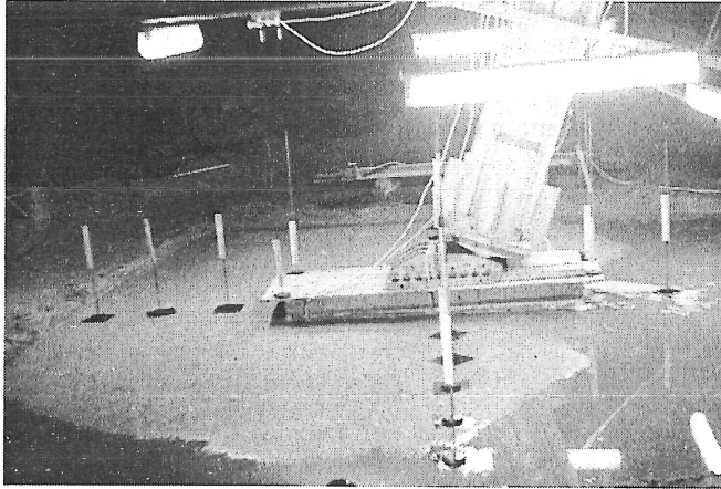
Bild 1: Großversuch der Degebo an Fundament mit Schrägbelastung (Weiß, 1978)
