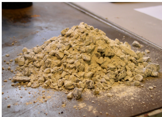
Bild 7.0.1: Das Korngerüst des Asphalts AC-12
