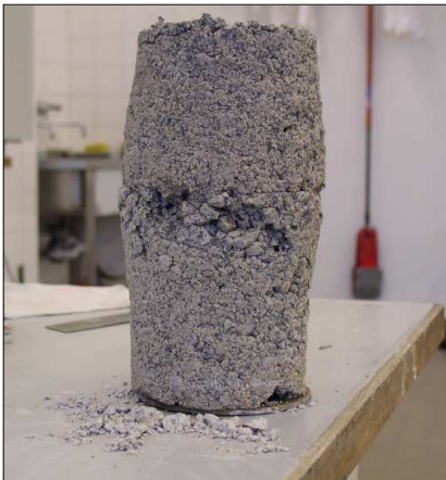
Bild 2: Eine wasserverdichtete Probe
