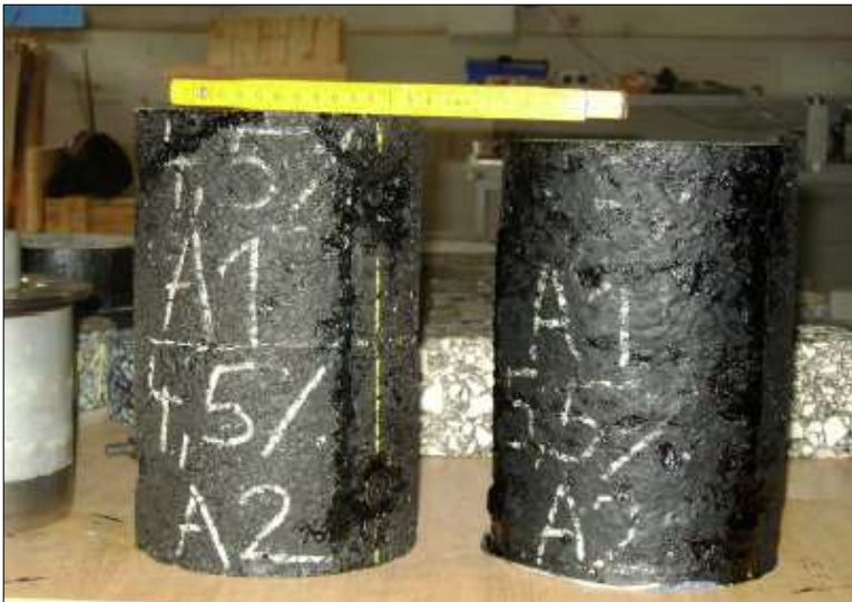
Bild 1-2: Einfluss des Bitumengehalts auf die akkumulierte Dehnung
