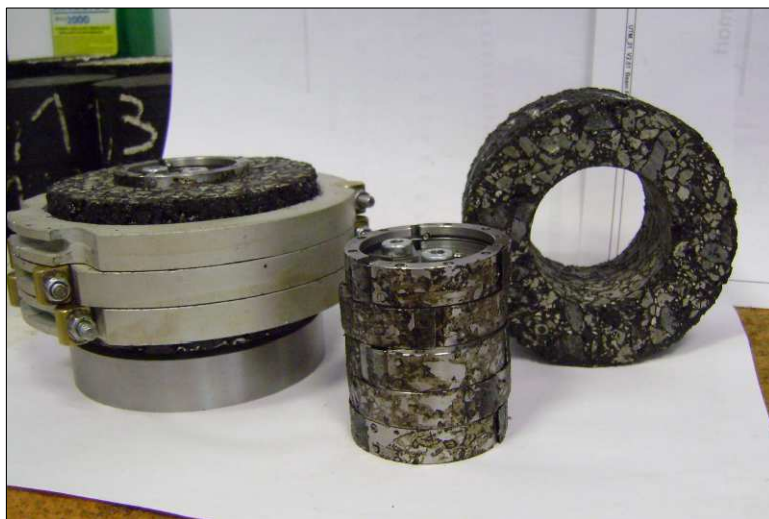
Bild 6: Innere und äußere Stützringe
