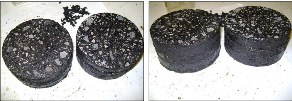
Bild 2: Asphaltproben mit hohem Bitumengehalt
