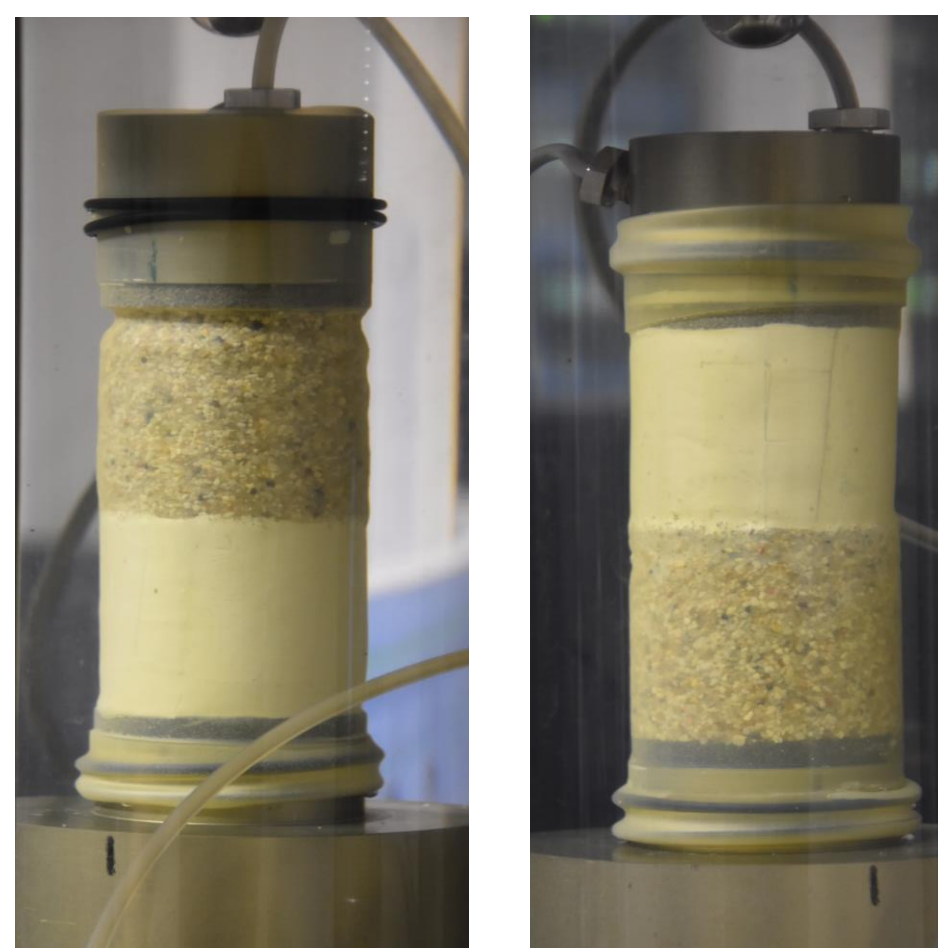
Abb. 4: zusammengesetzte inhomogene Probekörper
