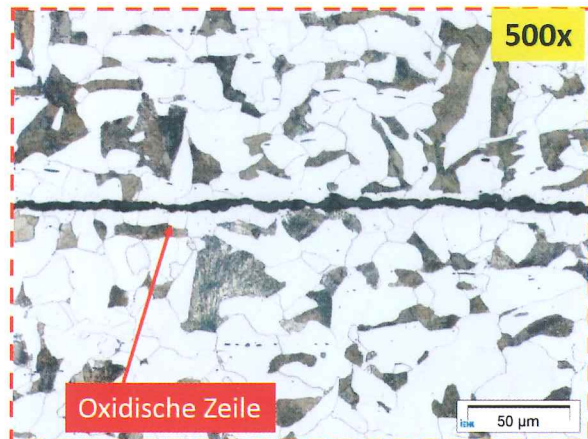
Bild 11.13: Oxidische Zeile in Blechmitte (Quelle: IWT Aachen)
