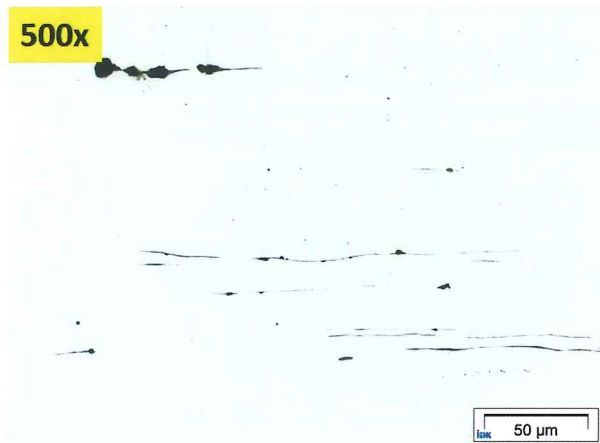
Bild 11.11: Typische Einschlussverteilung von Baustählen; hier: 1965, entnommen aus der Le-verkusener Brücke; sichtbar: langgestreckte Mangansulfide und ein oxidischer Einschluss (Quelle: IWT Aachen)
