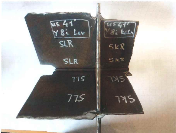
Bild 11.14: Ausgeschnittenes Bauteil – Längsrippe mit Querträger (Quelle: IWT Aachen)
