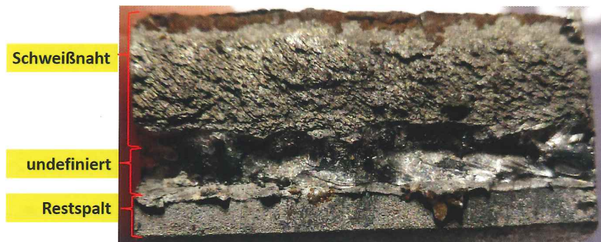
Bild 11.18: Bruchfläche Sektkelchstegseite (Quelle: IWT Aachen)
