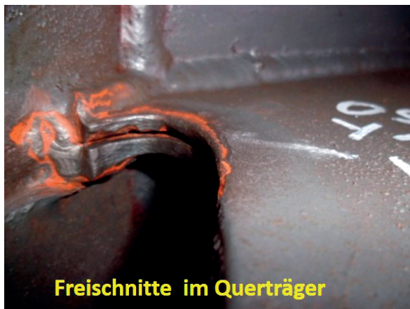
Bild 11.12: Aufreißung in Blechmitte (Quelle: IWT Aachen)
