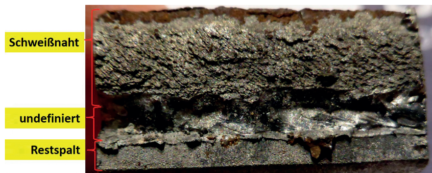
Bild 11.18: Bruchfläche Sektkelchstegseite (Quelle: IWT Aachen)
