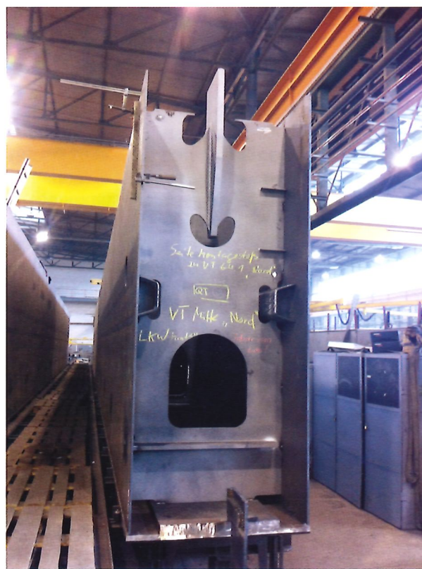
Bild 10.8: Werksfertigung Versteifungsträger mit Hängerschott
