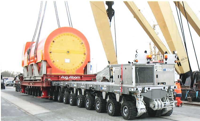
Bild 15.3: Transport eines Generatorständermittelteils mit angebautem Kühler (Foto: August Alborn GmbH & Co. KG)
