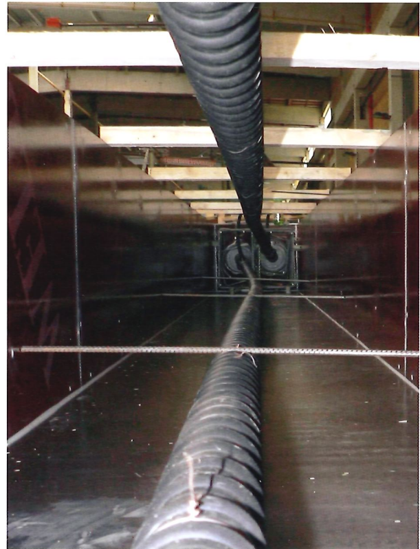
Bild 13.2: Schalung und Spannglieder des Versuchskörpers (Foto: TU Wien)
