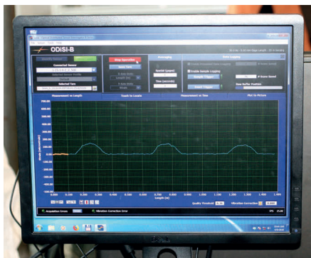
Bild 4 Quasi kontinuierliche Dehnungsmessung entlang der Messfaser mit drei Messstellen; links: Ausgabe während der Messung, rechts: ausgewählte Messstelle bei verschiedenen Laststufen
