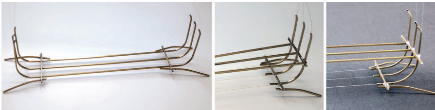
Bild 5 Trägergerüst aus Messing-U-Profilen zur Positionierung der Messfasern; links: Trägergerüst entlang der Messstelle, Mitte und rechts: Messbereich ohne Trägerprofil – Mitte: Polyimid-Coating, rechts: Acrylat-Coating
