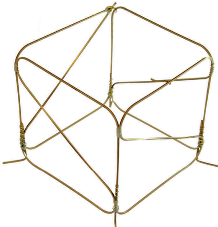
Bild 11 Trägergestell mit faseroptischen Sensoren für Dehnungsmessung in Betonwürfeln mit 10 cm Kantenlänge
