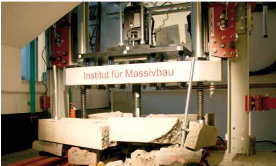
Bild 1: Ansicht des Spannfeldes mit Fallschlitten und zerstörter Probe
