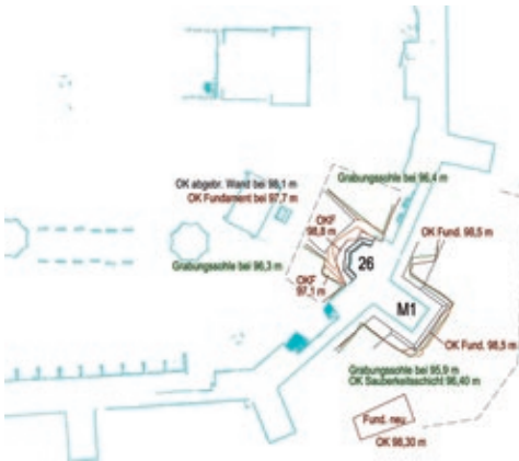
Bild 15: Schnitt durch die Punktwolke mit Eintragungen des Vermessers
