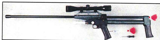
Abb. 2 Narkosegewehr JM (Foto: DANINJECT) und Narkosepfeil mit Sender (Fa. TELINJECT)
