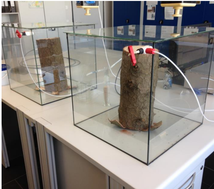
Geruchsmessung an Fichtenstämmen im Labor der Ifu GmbH
