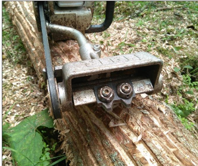
Rindenschlitzen mit dem Streifenmesser-Aufsatz als Anbaugerät für konventionelle Kettensägen; Foto: A. Hohenadl (LWF)
