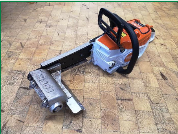
Schälgerät mit Streifenmessern und Kettenantrieb Foto: A. Hohenadl (LWF)
