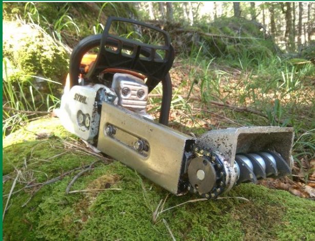
Borkenkäferfräse mit Kettenantrieb Foto: A. Hohenadl (LWF)
