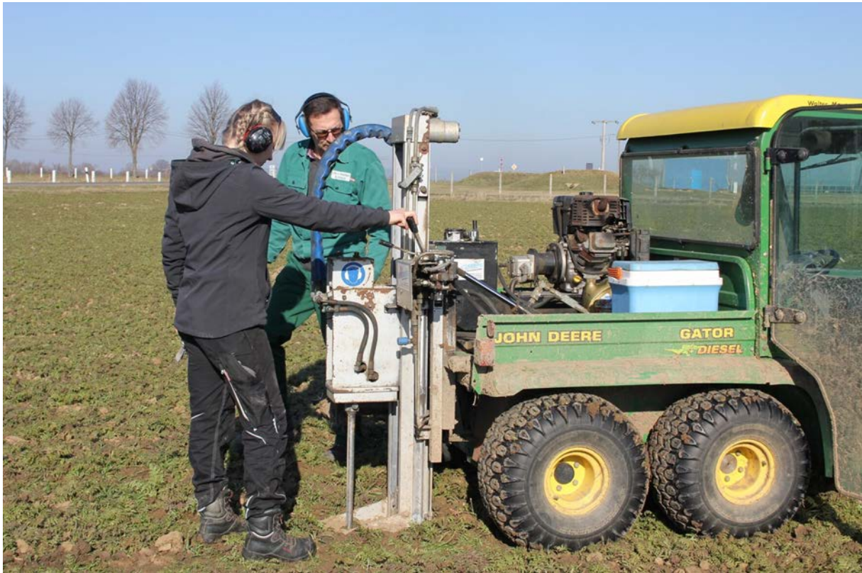
Abb. 21: Bodenprobenahme zur Ermittlung des pflanzenverfügbaren Bodenstickstoff durch das LfULG Sachsen [109]
