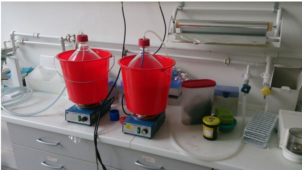
Abb. 15: Herstellung des Komposttees im Labor des IAK unter Rühren, Belüftung und Temperaturkontrolle
