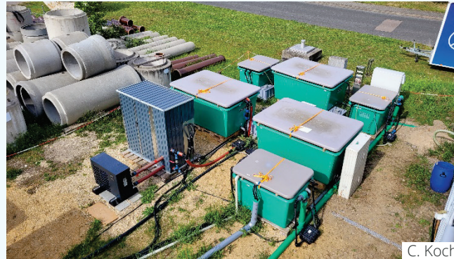
Pilotversuche zum biologischen Abbau MBBR + nachgeschalteter zweistufiger Vertikalfilter
