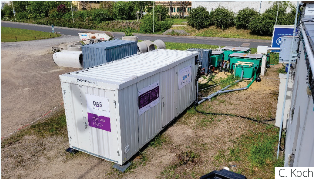
Pilotversuche zum biologischen Abbau MBBR + nachgeschalteter zweistufiger Vertikalfilter
