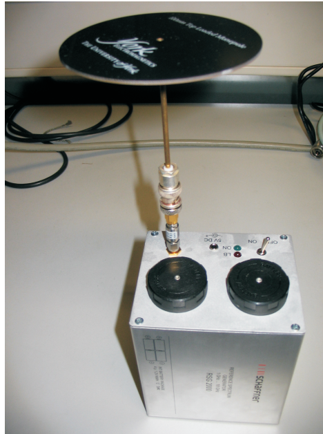
Abbildung 3.11: Kammgenerator »RSG2000« mit Abschwächer und aufgesetzter Monopolantenne.
