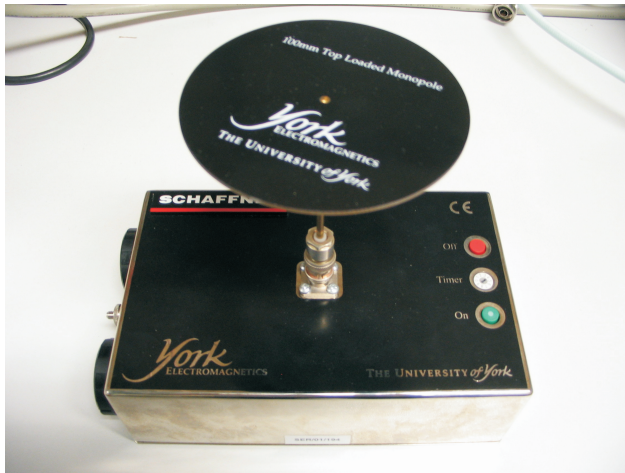
Abbildung 3.10: Der Rauschgenerator »CNEIII« mit 100 mm Monopolantenne.
