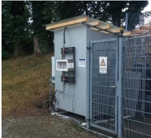
Bild 1: Lichtbogenversuchsstand am NARC zur Untersuchung synthetischer Lichtbogenzündungen
