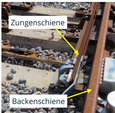
Bild 1: Weiche mit Backenschiene und Zungenschiene
