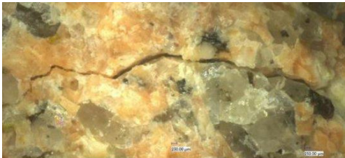
Bild 1: Risschädigung in Greisen
