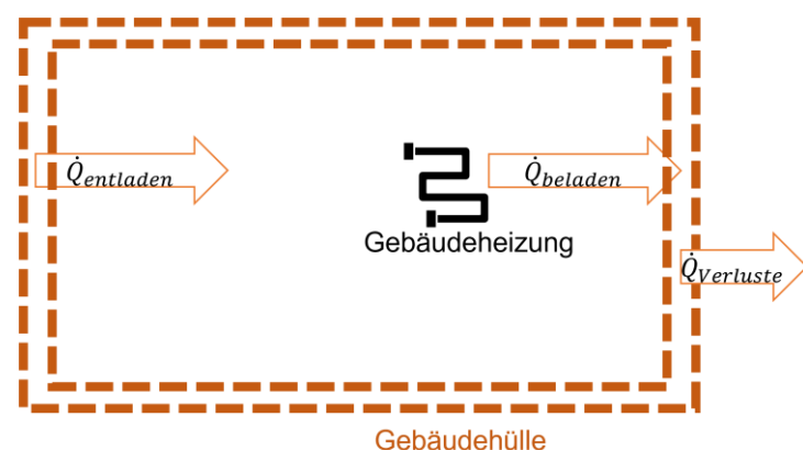
Abb.2: Wärmeströme Gebäudehülle als Speicher
