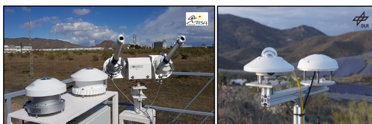
Abb. 1: Links zwei WISER I Spektroradiometer für GHI und DNI, rechts ein DLR-PyranCam-Messsystem ausgestattet mit einer Mobotix Q26 Wolkenkamera und einem CMP21 Pyranometer.
