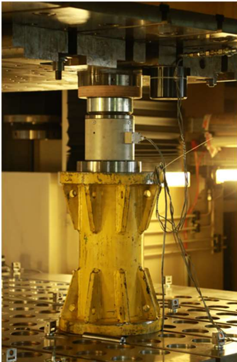
Belastungssäule mit Kraftmessdose bis 40 MN
