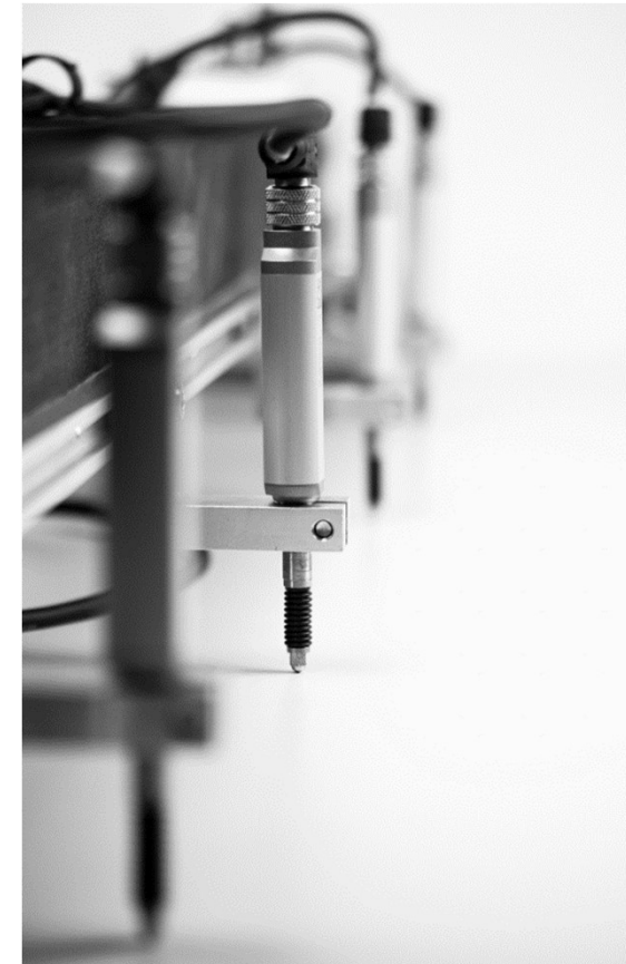
Analyse der Ebenheit einer Stößelspannfläche
