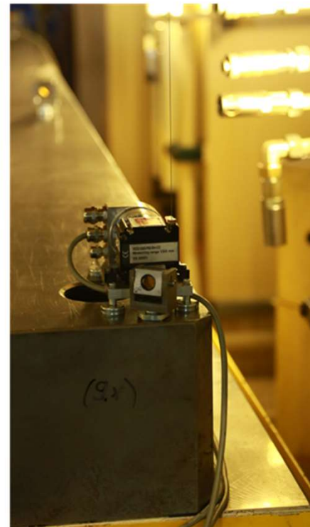
Seilzugaufnehmer bis 1500mm Messweg
