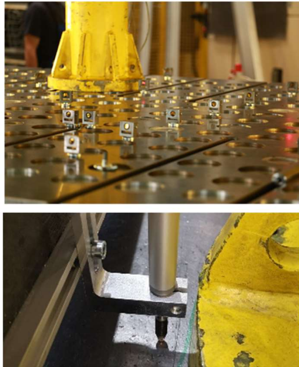
Reflektor-Targets für Lasertrackermessungen, Taktile Sensor zu Verlagerungsbestimmung
