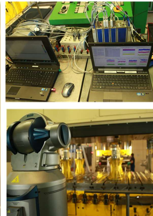
Datenaufnahme-Setup und Lasertracker vor einer Presse
