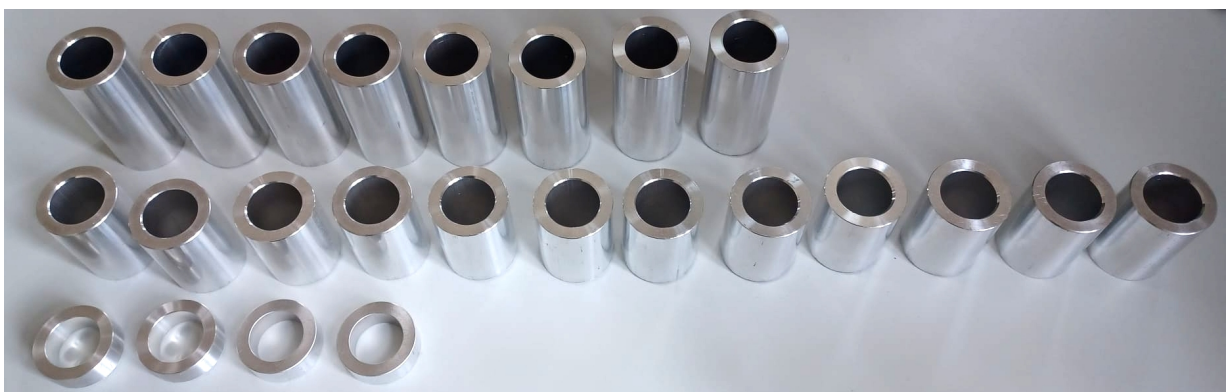
Abbildung 12: Röhrenset (8 mal mit Länge 75 mm, 12 mal mit Länge 50 mm und 4 mal mit Länge 12,5 mm).
