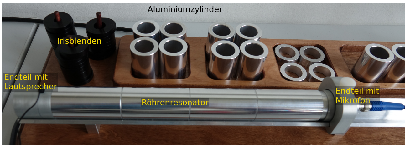
Abbildung 3: Versuchsaufbau Röhrenresonator: durch das Aneinanderreihen von Aluminiumzylindern können Röhrenresonatoren unterschiedlicher Länge aufgebaut werden. Am rechten Ende befindet sich ein Mikrofon, am linken Ende ist ein Lautsprecher eingebaut, über den die Schallwellen in das System eingekoppelt werden.
