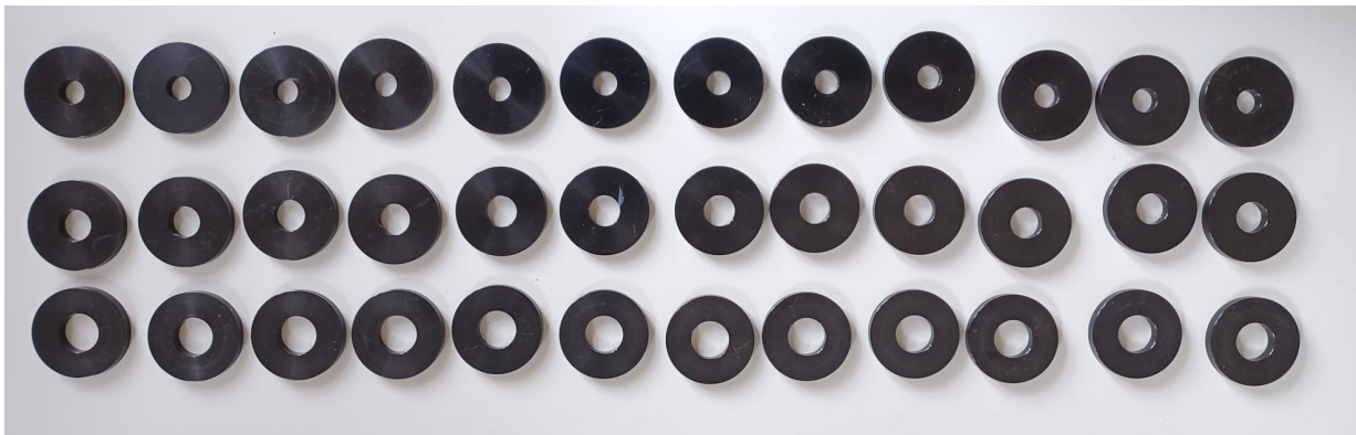
Abbildung 11: Scheibchenset (Jeweils 12 Stück mit Innendurchmesser 10 mm, 13 mm und 16 mm).
