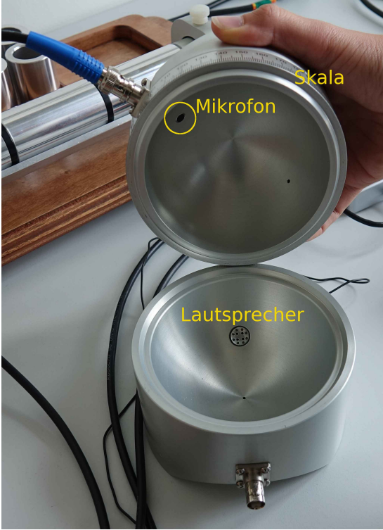
Abbildung 4: Links: Der Kugelresonator wird aus zwei Halbkugeln zusammengesetzt, in die ein Mikrofon und ein Lautsprecher eingebaut sind. Durch Verdrehen der beiden Hemisphären gegeneinander, kann die Winkelabhängigkeit der Amplitude einer stehenden Welle ausgemessen werden. Rechts: Für die sphärische Geometrie ist die Symmetrieachse durch den Lautsprecher bestimmt, welche die Ausrichtung der stehenden Wellen, die sich im Resonanzfall ausbilden, bestimmt.
