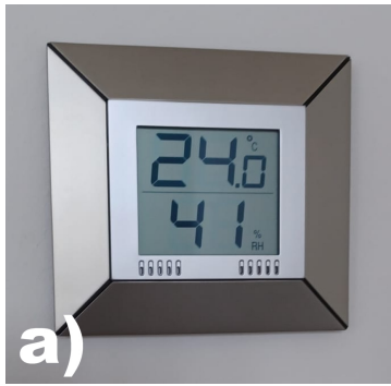
Abbildung 13: a) Raumthermometer mit Luftfeuchtigkeit; b) Schiene für Röhrenresonator.
