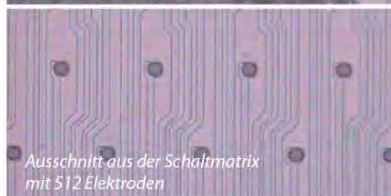
Retina eines Salamanders auf einer Schaltmatrix mit 512 Elektroden
