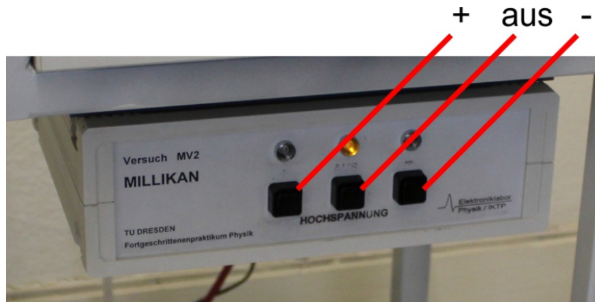
Abb. 3: Umschaltung für die Hochspannung. Damit kann die Polarität der Hochspannung an dem Plattenkondensator um- oder ausgeschaltet werden.
